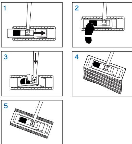
1. Geschlossenen Halter mit der Haken-seite in einen Haltegurt einführen.
