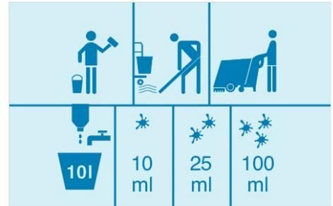
3. Reinigungslösung in einem Eimer oder im Tank der Reinigungsmaschine vorbereiten. Je nach Verschmutzungsgrad 10-100 ml MAXX Magic S zu 10 L Wasser geben. Für eine Unterhaltsreinigung mit normaler Verschmutzung 25 ml MAXX Magic S mit 10 L kaltem Wasser mischen. Für die Reinigung von Bodenbelägen mit Dispersionsbeschichtung max. 1,5 % verwenden.
