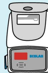
4. Wenn der Alarm ertönt (rotes Display), ist ein neuer Produktblock einzusetzen. Der Alarm lässt sich entweder durch Drücken der Taste unter dem Display oder durch Öffnen der Gehäuseabdeckung abschalten.
