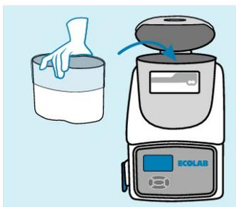
7. Neuen Produktblock in den Vorratsbehälter einsetzen. Oberen Teil der Plastikfolie entfernen. Das Display wird automatisch blau. Abdeckung schließen.
